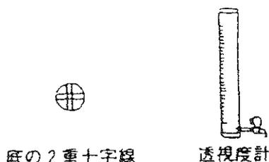
※ 50cm以下のときは1m透視度計を分解して、50cm計にして再度測定します。
